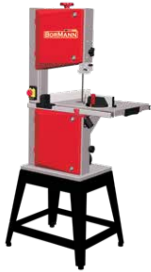
BB53000 017073 ΠΡΙΟΝΟΚΟΡΔΕΛΑ ΞΥΛΟΥ ΜΕ ΒΑΣΗ • Ισχύς 750W • Ταχύτητα κορδέλλας (2) 360/720m/min • Μήκος κορδέλλας 2240mm • Ύψος κοπής 175mm • Πλάτος κοπής 305mm • Διαστάσεις τραπεζιού με προέκταση M40xΠ86cm
