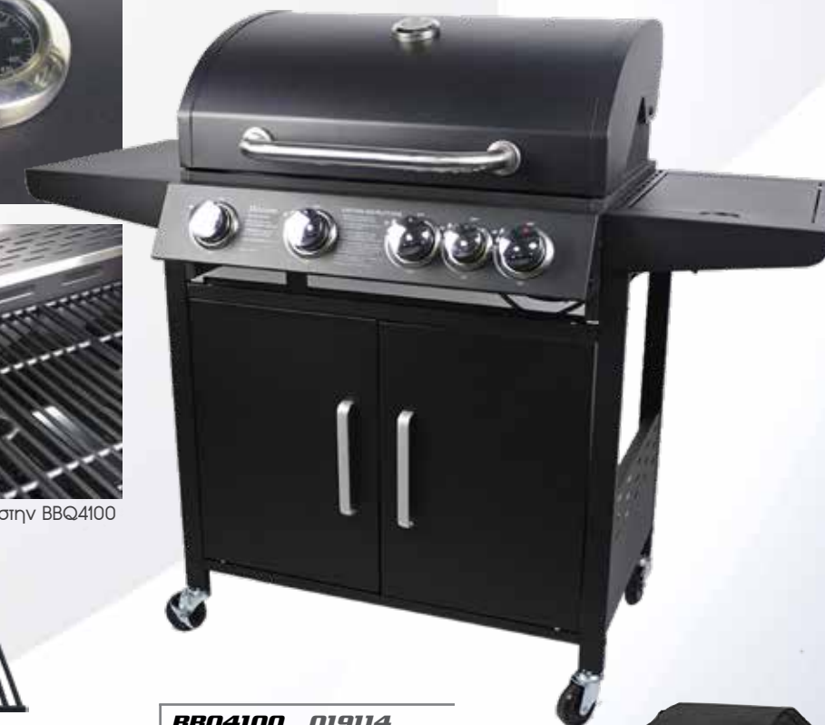
BBQ4100 019114 ΨΗΣΤΑΡΙΑ ΥΓΡΑΕΡΙΟΥ • Ισχύς 17.1kW • 4 Εστίες (x3.6kW) + 1 πλαινή Εστία (2.7kW) • Επιφάνεια ψησίματος M69xΠ45cm • Μαντεμένα σχάρα με εμαγιέ επικάλυψη • Ανοξείδωτο θερμομέτρο • Διακόπτες αυτόματης ανάφλεξης • Αφαιρούμενος συλλέκτης λίπων • 2 Ρόδες • Πλαινό μεταλλικά ράφια • 2 Μεταλλικές μπροστινές πόρτες κάλυψης ραφιού
